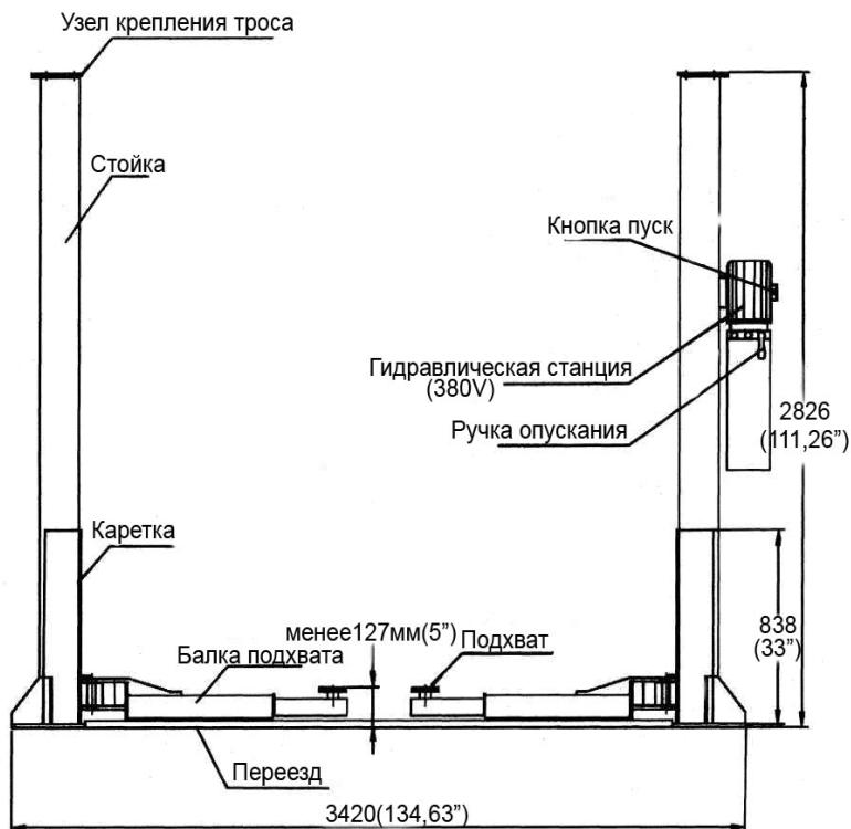
Рис.4. Структура подъемника
