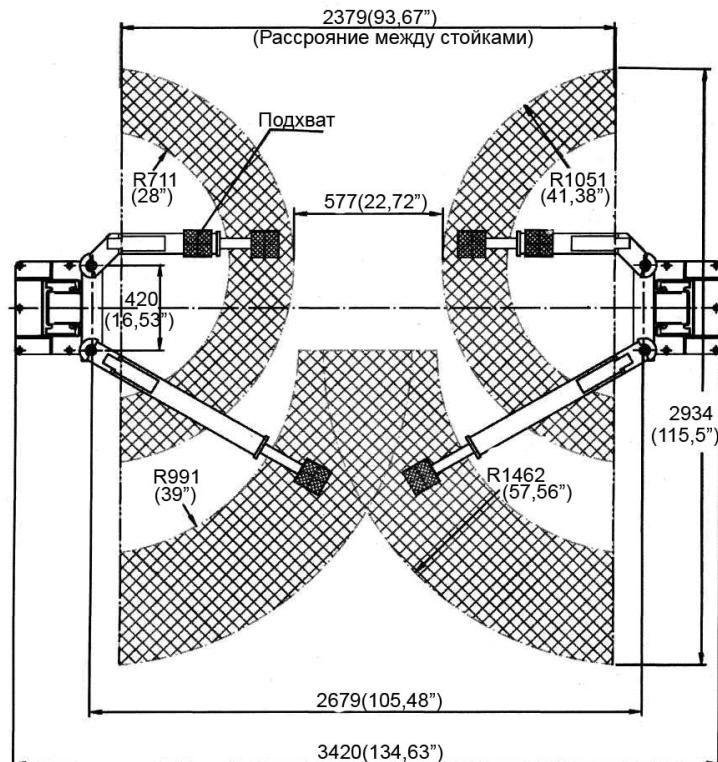
Рис. 5. Схема рабочей зоны.
